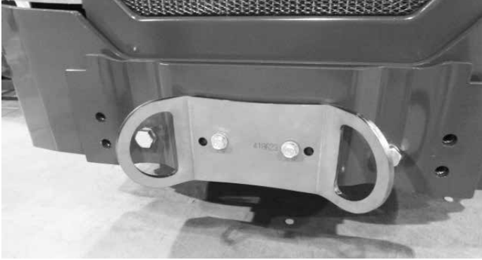
Sidontakiinnike A418623 asennettuna takapuskuriin tai takapainoon
