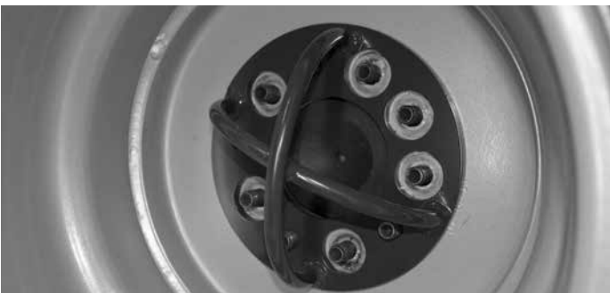
Sidontakiinnike pyörän napaan A423091
